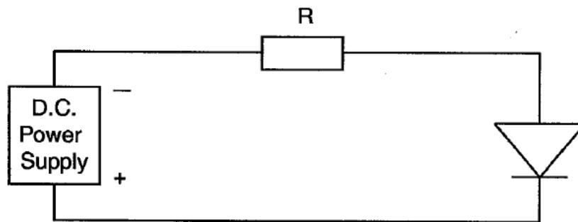
**FIGURE 5(b) - ELECTRICAL CIRCUIT FOR POWER BURN-IN**
